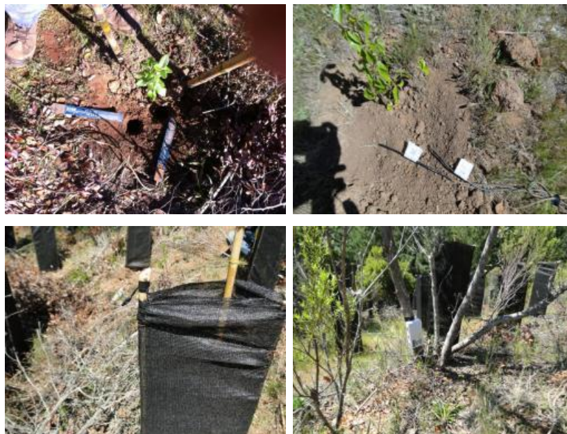
Figura 18. Instalación de sensores de contenido volumétrico de agua, humedad relativa dispuesto fuera de malla de protección y almacenador de datos dispuesto en campo.
