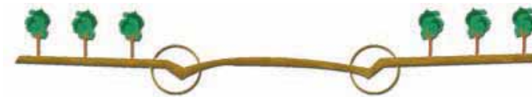
Figura 2: Canales de desagüe a ambos lados del camino
