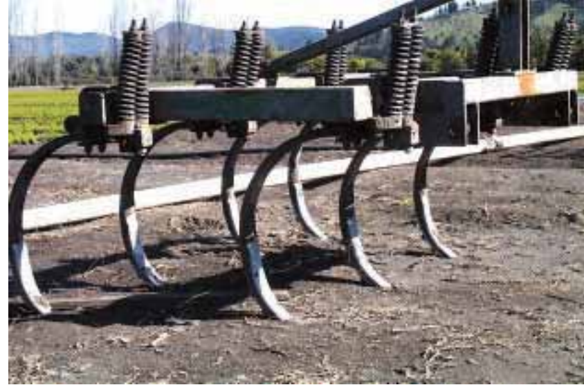
Arado Cíncel de 7 puntas (arriba). Suelo franco arenoso cíncelado a 25 cm (abajo) (Vivero Proplantas, 2000)
